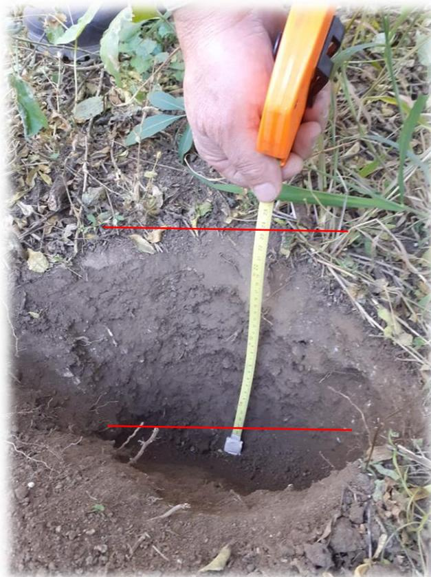
**FIGURA 12.** Calicata descubriendo un Horizonte A poco profundo, con variación en las tonalidades castañas (materia orgánica y humedad) e incremento de la granulometría.-
